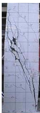
③S05 試験体(曲げせん断耐力比 0.72, せん断破壊)
