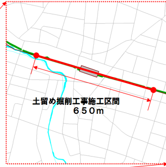
山留め工事における地下水流遮断
