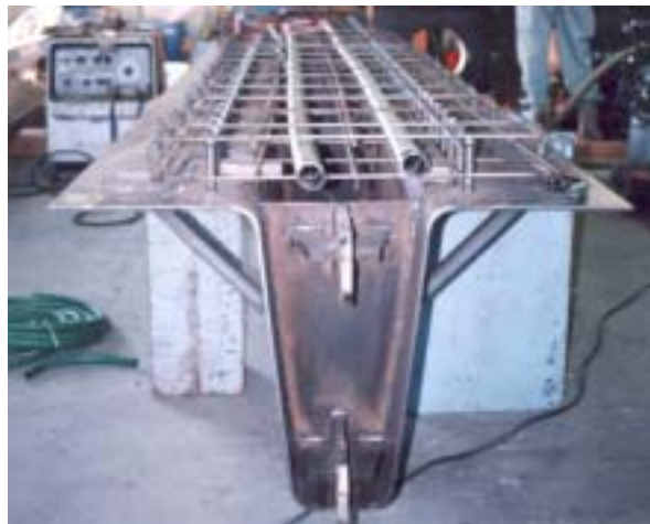
図 4.5 コンクリート打設前の試験体 U2
