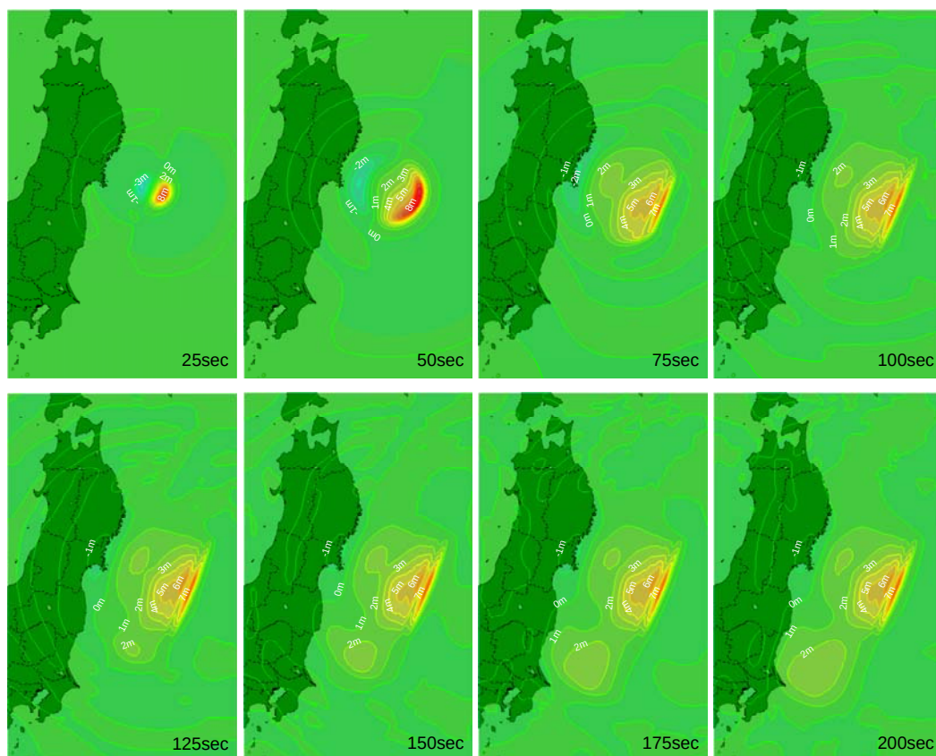
図6 地震動シミュレーションから得られた鉛直変位分布の時間変化
