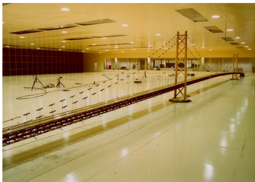
図 5.9 全橋模型試験(明石海峡大橋)
