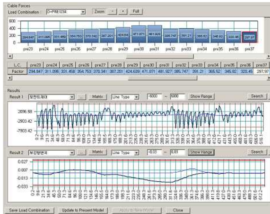
ケーブル力のチューニング機能で調製した張力によるモーメント図
